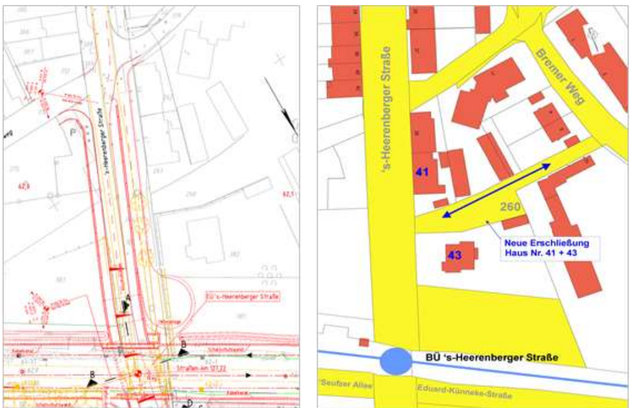
Abbildung 6 Ausschnitt DB-Planung (links) und Planung Stadt Emmerich am Rhein Neue Erschließung Haus-Nr. 41 + 43 (rechts)
